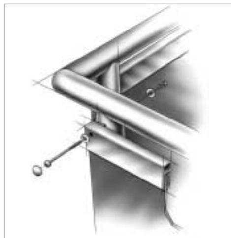
Ab einer Plattenstärke von 6 mm können Trespa Meteon-Platten durch vierseitige oder zweiseitige Einfassung mittels Rahmenprofilen bzw. Einfassleisten befestigt werden. Die Einfassleisten/Rahmen müssen als statisch tragende Linienauflager wirken.
