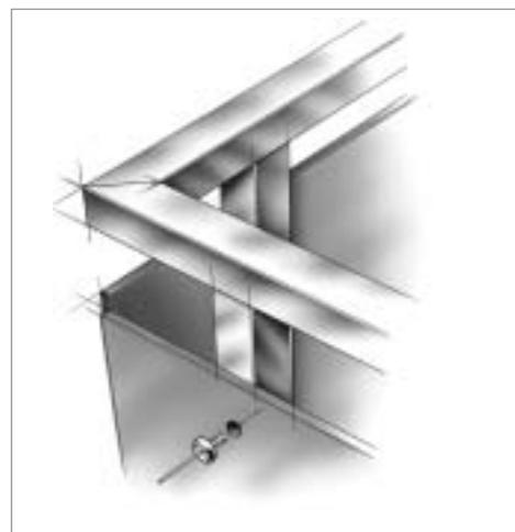
Befestigung mit Blindnieten aus Aluminium oder Edelstahl; erhältlich mit lackiertem Kopf oder mit Abdeckkappe in allen Trespa Meteor-Farben. Für eine Stahl- Unterkonstruktion dürfen nur Edelstahlnieten eingesetzt werden.
